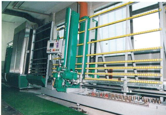
topDRILL 130 cnc mit Waschmaschine
