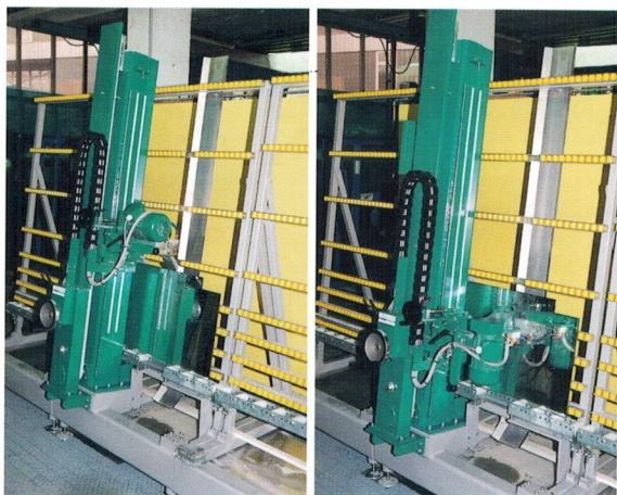
Diamantsäge um 90° schwenkbar – Detail
